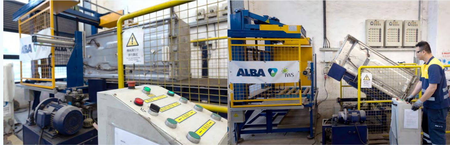
雪櫃處理線的原有設計適用於總容積約為500公升的雪櫃。為配合《廢電器電子產品生產者責任計劃》新增的涵蓋總容積高達900公升的雪櫃，我們有必要修改處理流程。
